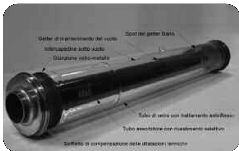
Figura 2 Foto di un tubo ricevitore ENEA con indicazione dei vari componenti
